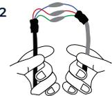
4.- Realice el aislamiento cubriendo la cinta vulcanizable desde el conductor de alimentación en dirección del cable de la luminaria.
